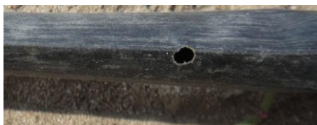
Uszkodzona przez gąsienice linia nawadniająca
