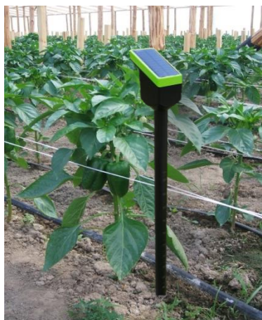
Fot. 4. Bezprzewodowa sonda pomiarowa AM-100. (fot. A. Stębowska)
